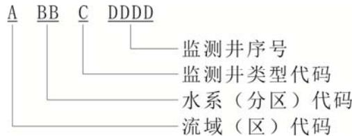
图F.1 地下水监测井代码组成
