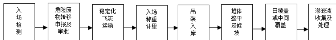
图 6.2 稳定化飞灰吊装式填埋作业流程
